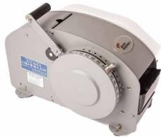
2本のブラシが均一に水付を行い、内蔵された水タンクが水位を一定に保つため、ムラなく接着させることができます。水タンクにはヒーターを取り付けることもできます。
